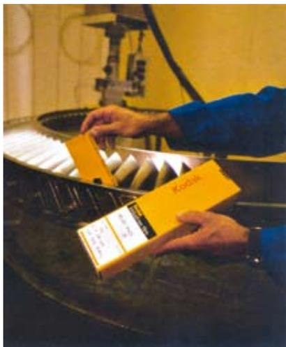
Плѐнка KODAK INDUSTREX T200 рекомендована для использования в ответственных областях, поскольку она может использоваться одновременно с другими пленками в многопленочной технологии и давать дополнительную информацию о скрытых дефектах. В ней использована запатентованная Kodak эмульсия T-GRAIN.
