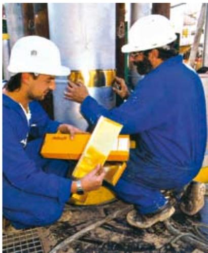
Плёнка KODAK INDUSTREX M100 обеспечивает превосходную резкость изображения и предназначена для ответственных задач рентгенографии, особенно при работе с рентгеновским излучением высоких энергий и гамма-излучением. В ней используется запатентованная Kodak эмульсия T-GRAIN.
